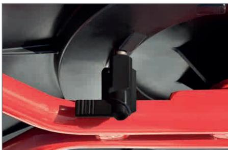
massive Bremse mit Feststellmechanismus
